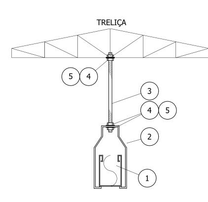
DESCRIÇÃO PERFILADO DE AÇO GALVANIZADO A FOGO / ELETROLITICO ( EXT / INTERNO ) 38x38mm SUPORTE SUSPENSÃO PARA TIRANTE DE AÇO GALVANIZADO TIRANTE / BARRA ROSCADA Ø3/8" x 3000MM DE AÇO GALVANIZADO PORCA SEXTAVADA DE AÇO GALVANIZADO Ø3/8" ARRUELA LISA DE AÇO GALVANIZADO Ø3/8"
