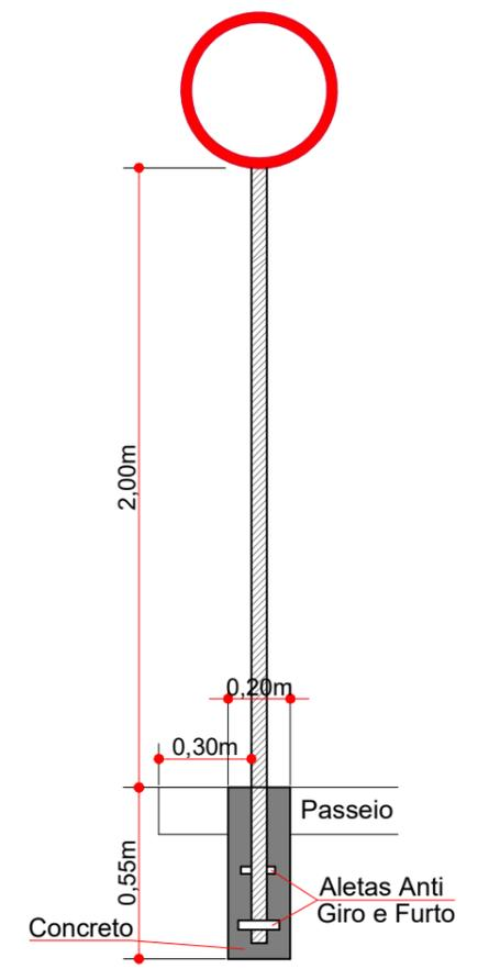
DETALHE DA FIXAÇÃO DE PLACAS
