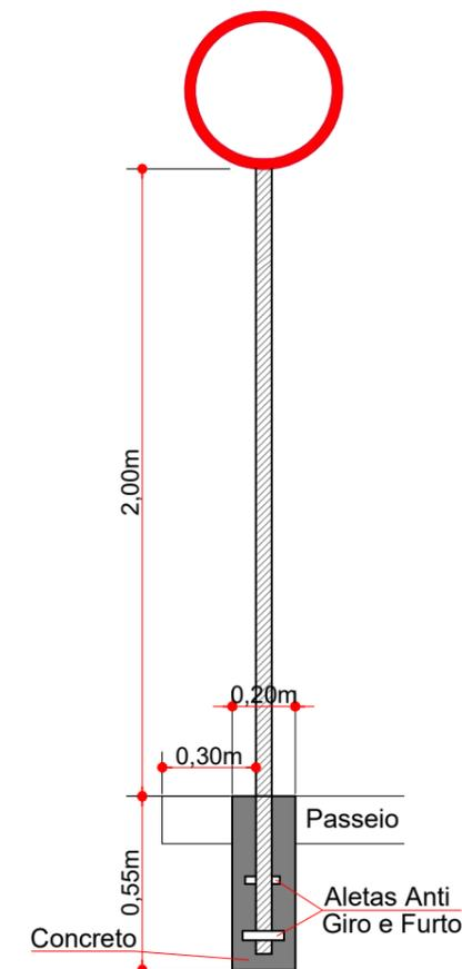
DETALHE DA FIXAÇÃO DE PLACAS
