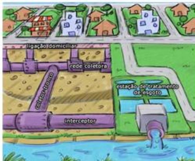
**Figura 3 – Sistema de Esgotamento Sanitário**
