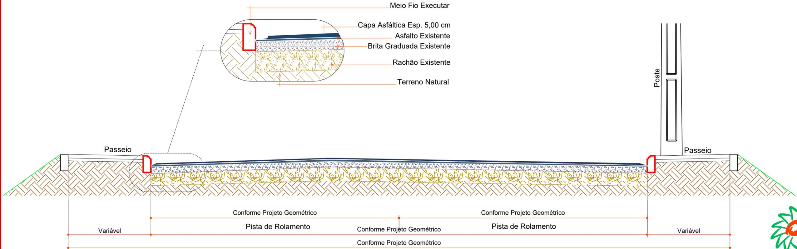
SEÇÃO TRANSVERSAL A SER EXECUTADA NOS TREHOS DE RECAPEAMENTO ESTACA 0.P.P ATÉ 29.6.338 m
